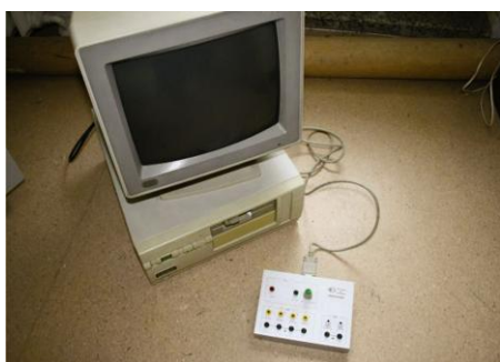
Fig.1. Regjistrues elektronik matjesh, Coach panel 1994
